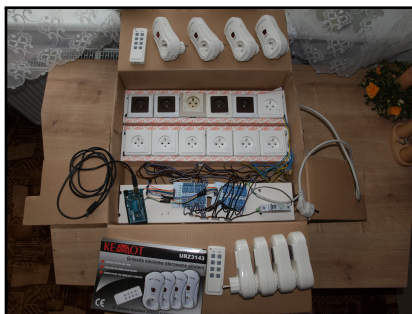
Obrázek 2. Řešení se 12 zásuvkami a 8 dálkově ovládanými zásuvkami (RF, firma Kemot)
